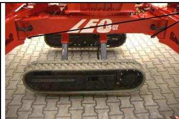
Danach die beiden Verriegelungen mittels Handpumpenhebel lösen (1.Person).
