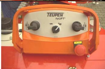
Kabelfernbedienung für Kettenfunktionen mit Umschaltung Schnell-Langsam (bei Nichtgebrauch unbedingt den Überbrückungsstecker einsetzen)
