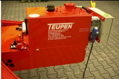
Hydrauliktank, 230-V-Anschluss, Steuergehäuse und Ventilblock für Notsteuerung hinter dem Verkleidungsblech
